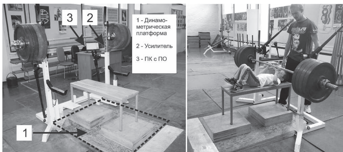
Рис. 1. Устройство для регистрации максимальной силы разгибания рук в статических условиях (ФГБОУ ВПО «РГУФКСМиТ»)
