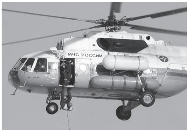
*Рис. 7. Десантирование спасателей с использованием альпинистской веревки и спускового устройства*
