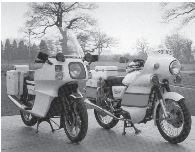
Слева – «Norton Interpol 2» 1984 года выпуска с роторным двигателем; справа – «Norton Commando Interpol» 850 см 3 , 1976 года выпуска, с двухцилиндровым двигателем мощностью 59 л.с., 4-ступенчатой кпп, дисковыми тормозами с гидравлическим приводом. Оснащен специальным полицейским оборудованием
