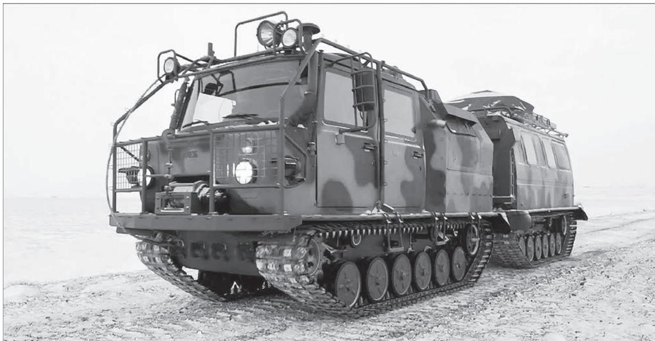
Рисунок 4 – Двухзвенный гусеничный транспортер-тягач ГАЗ-3344-20
