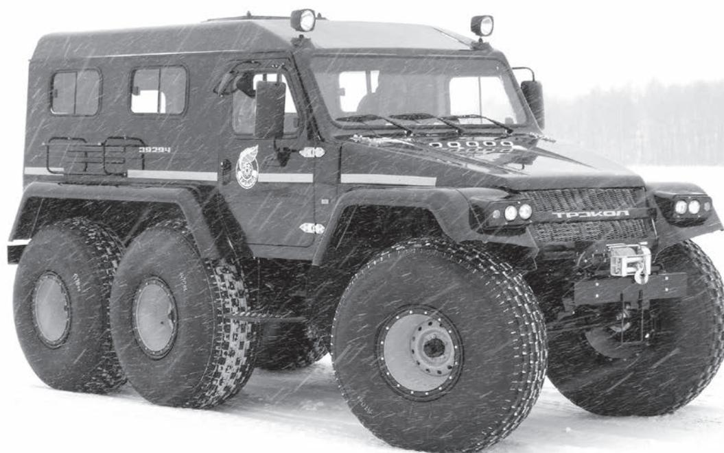
*Рисунок 5 – Вездеходное транспортное средство ТРЭКОЛ-39294 (автомобиль-амфибия на колесах сверхнизкого давления)*
