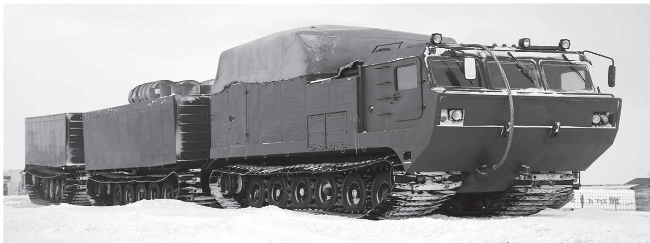
*Рисунок 3 – Двухзвенный гусеничный транспортер ДТ-30 ПМ (с неактивным прицепом для топлива)*
