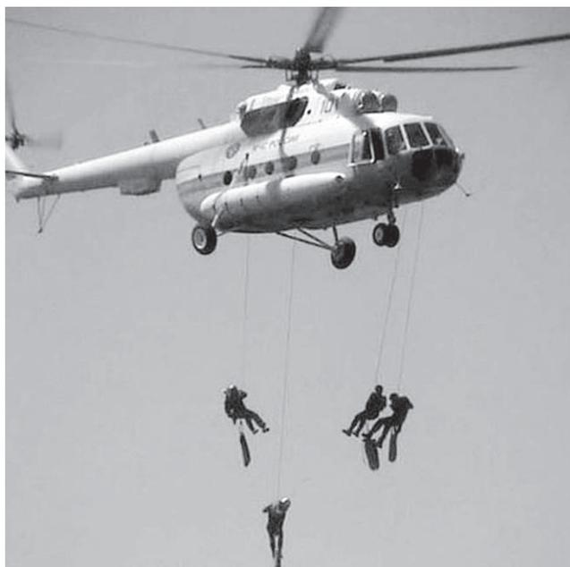
*Рисунок 1 – Десантирование спасателей с использованием спусковых устройств*
