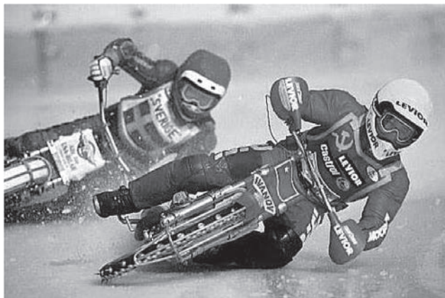
Рисунок 2 – Предельный наклон мотоцикла (до 68°) возможен только при наличии в его шинах специальных металлических шипов. В качестве дополнительной опоры используется левая нога. Голова спортсмена, для эффективной работы вестибулярного аппарата, в процессе прохождения поворота находится в близком к вертикальному положению
