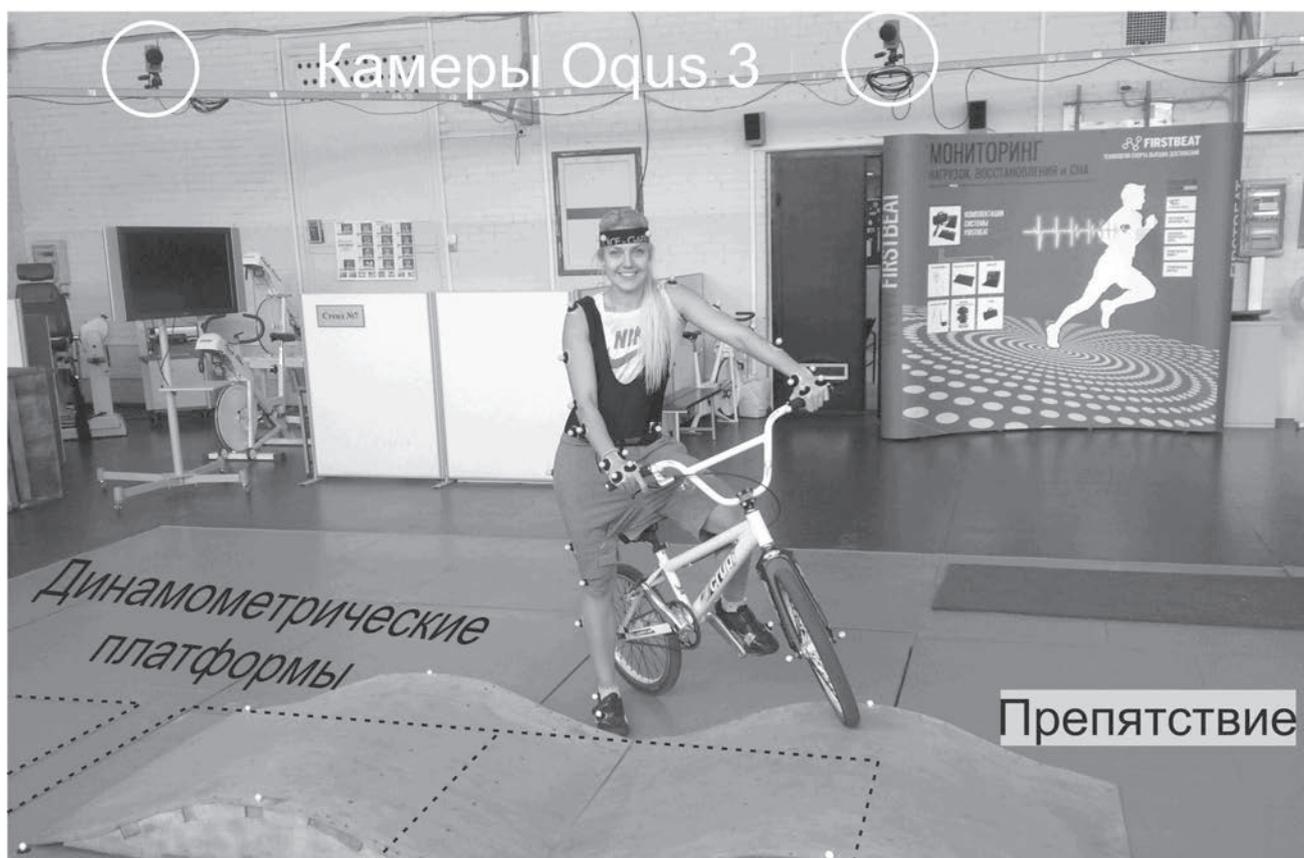
Рисунок 2 – Оптико-электронный и динамометрический аппаратно-программный комплекс Qualisys
