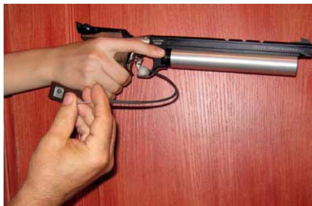
**Рисунок 1. – Пневматический пистолет с тросиком от фотоаппарата (Фото А.П. Поддубного)**
