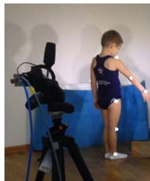
Рисунок 2 – Схема расположения световозвращающих маркеров на теле испытуемого
